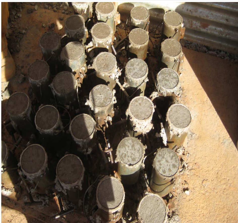
Foto 26 – Ensaio – Moldagem de corpos de prova
