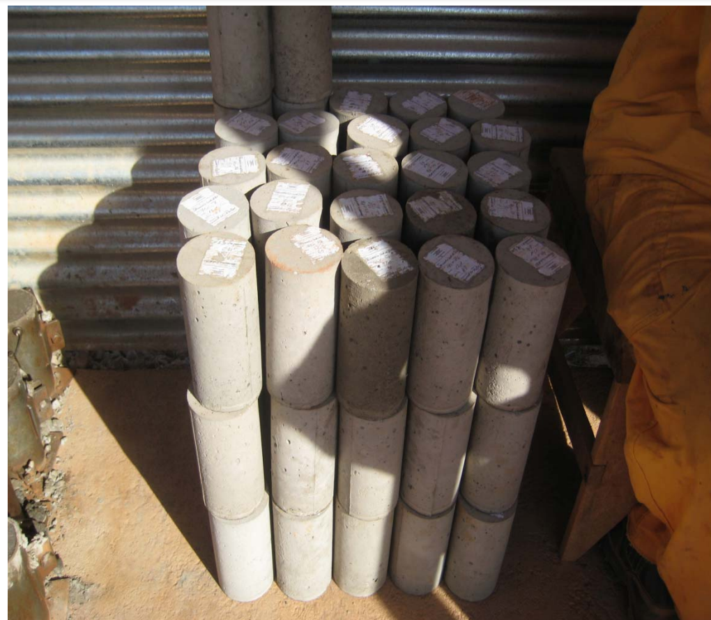
Foto 27 – Ensaio – Corpos de prova identificados para análise de laboratório
